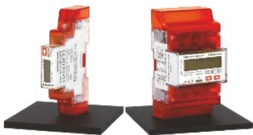
Power meter monofase e trifase certificati MID con comunicazione seriale RS485 Modbus. Inserzione diretta fino a 45 A per il monofase, 100 A per il trifase.
