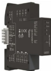
Power meter trifase sviluppato in 17,5 mm di spessore. Ingresso UNIVERSALE per trasformatori amperometrici (1/5 A, 333 mV, Rogowski), uscita RS485 Modbus e contatto digitale.
