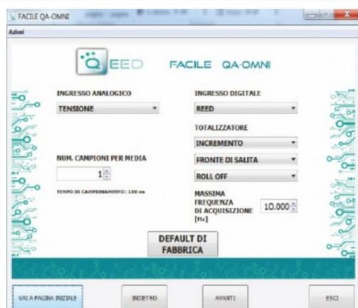
I SOFTWARE DI CONFIGURAZIONE "FACILE" PERMETTONO DI CONFIGURARE LIBERAMENTE I MODULI "QA" ATTIVANDO LE FUNZIONI DI INTERESSE E SCALANDO GLI INGRESSI E LE USCITE A PIACIMENTO.
