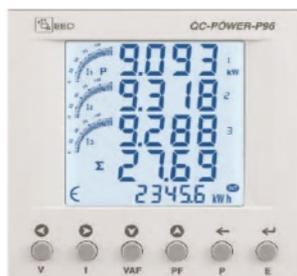
Power meter e analizzatore di rete 96 x 96 mm per montaggio a pannello. Supporta trasformatori di corrente con secondario 1 A e 5 A, uscita RS485 Modbus e digitale. Esegue analisi armoniche fino alla 31esima e misura del THD.
