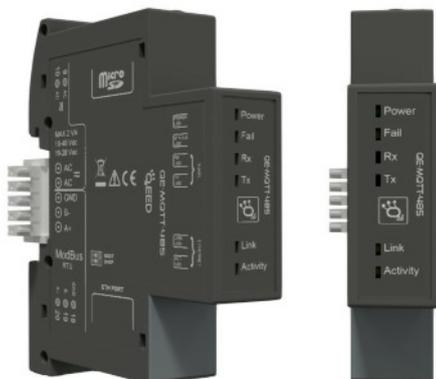
**Il QE-MQTT-485 è un gateway industriale con supporto ai protocolli Modbus RTU/TCP e MQTT**
