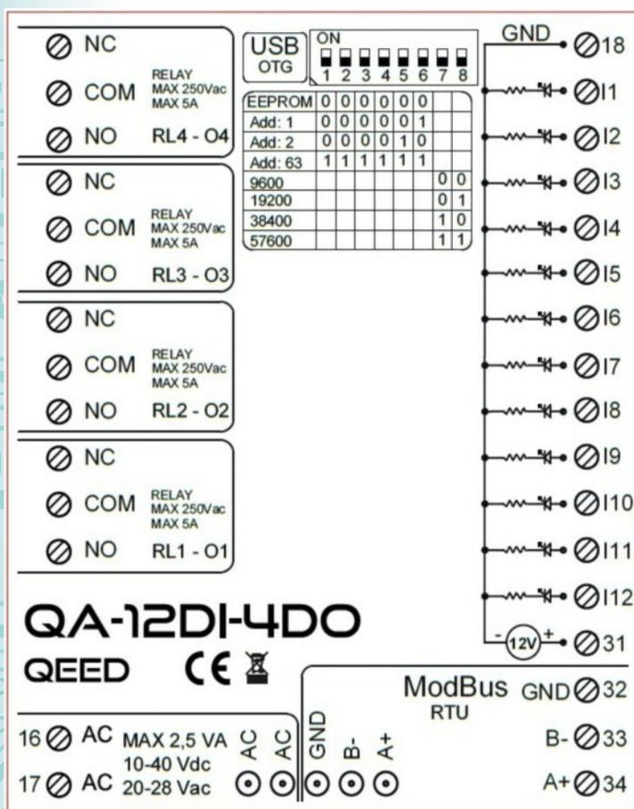
**CONFIGURAZIONE INDIRIZZI MODBUS E BAUDRATE VIA DIP-SWITCH**
