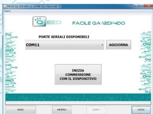
E' possibile utilizzare il programma senza la connessione al modulo, in questa modalità potrete SALVARE la configurazione sul vostro PC per poterla poi inviare al QA-12DI-4DO in un secondo momento.
