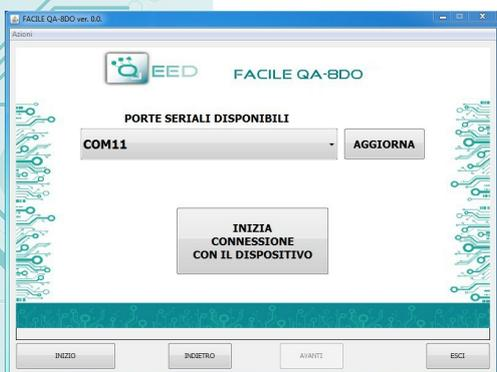
E' possibile utilizzare il programma senza la connessione al modulo, in questa modalità potrete SALVARE la configurazione sul vostro PC per poterla poi inviare al QA-8DO in un secondo momento.
