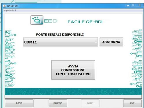
E' possibile utilizzare il programma senza la connessione al modulo, in questa modalità potrete SALVARE la configurazione sul vostro PC per poterla poi inviare al QE-8DI in un secondo momento.
